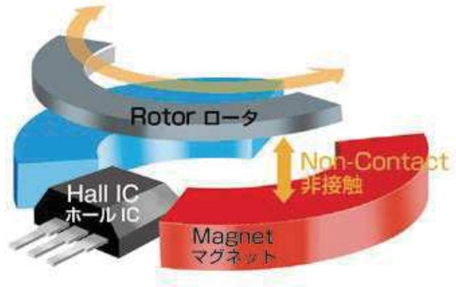
RSM12Cは、ホールICを使用した小型の非接触方式角度センサです。独自の磁気回路設計により、薄型基板実装タイプの小型非接触角度センサを実現しました。その他の出力範囲や有効電気角をご要望の場合は当社宛てご相談ください。
